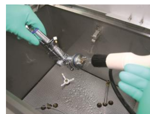
Vorreinigung mit dem Pinsel direkt über der Washkammer mit Absaugung
