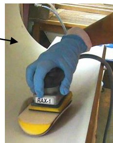
RAX-1 + RL-HSV04 beim Schleifen einer konkaven Fläche.
